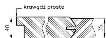
Przekrój poziomy drzwi Elsa
